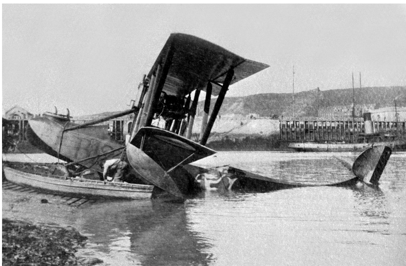
Tellier B-12 200hp avec sirène posé en mer et abîmé par un bateau remorqueur le 15/05/1918 après un posé en mer, à Dieppe ? Source ARDHAN Lepetit
